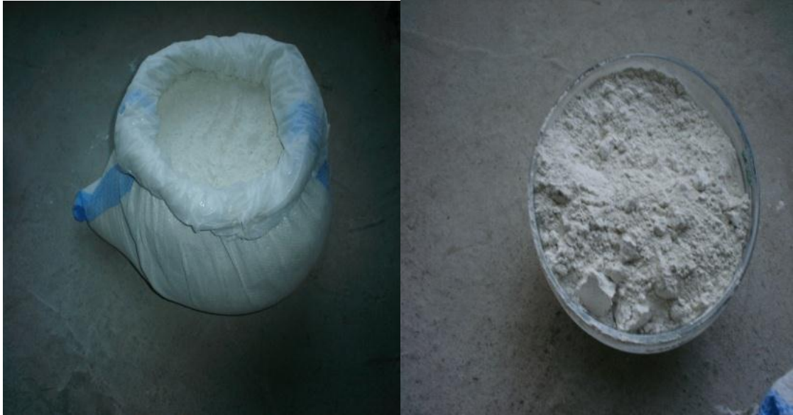
شكل رقم (22) الكلس الحي المطحون .
