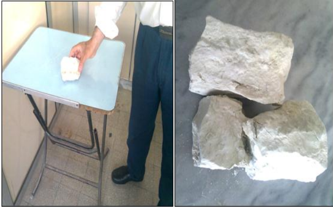
شكل رقم (5) الكلس الحي (CaO) المستخدم في البحث وهو بشكل كتل حجرية قبل طحنه
