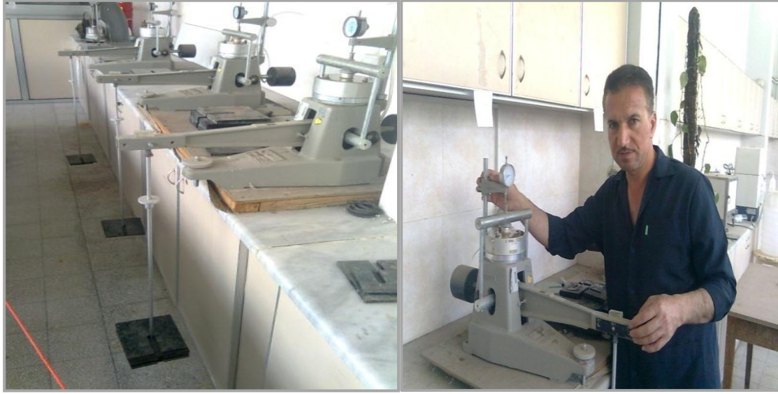
شكل رقم ( 81 ) إجراء تجارب الانتفاخ النسبي و ضغط الانتفاخ باستخدام جهاز الأدمتر.
