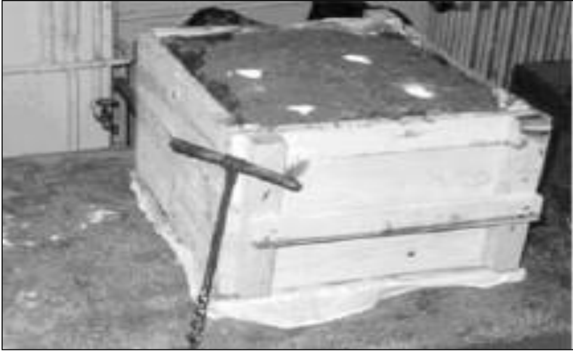
شكل رقم ( 35 ) تنفيذ الأوتاد الكلسية المخبرية في عينة التربة غير المخربة
