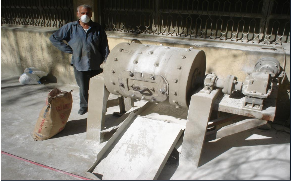
شكل رقم (6) مطحنة الكرات في معمل الاسمنت في عدرا المستخدمة لطحن الكلس الحي.
