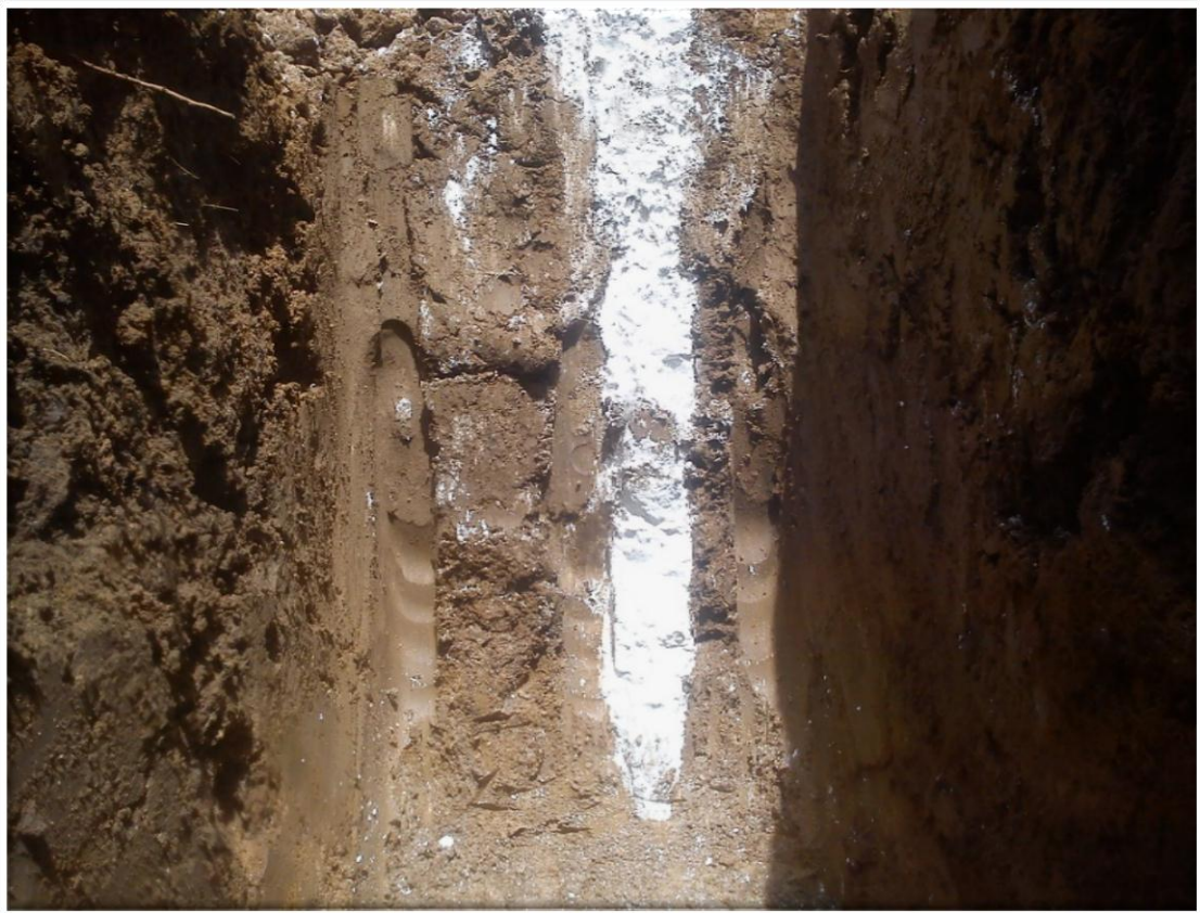
شكل رقم (15) الوتد الكلسي المنفرد بعد ( 520 ) يوم على تنفيذه بالتربة.
