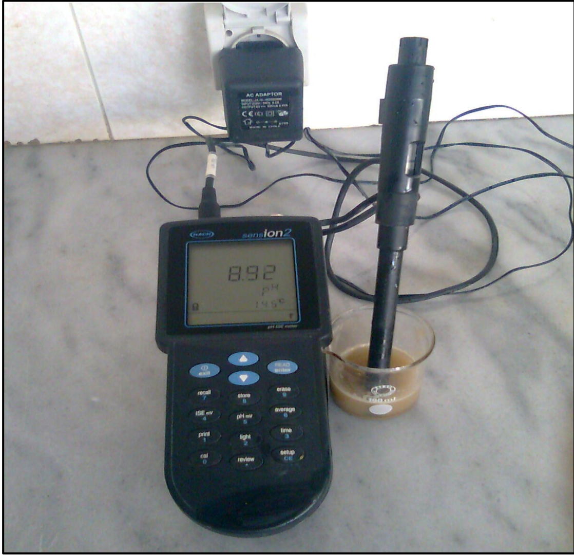
شكل رقم ( 88 ) الجهاز المستخدم في قياس قيمة ( PH ) في التربة .
