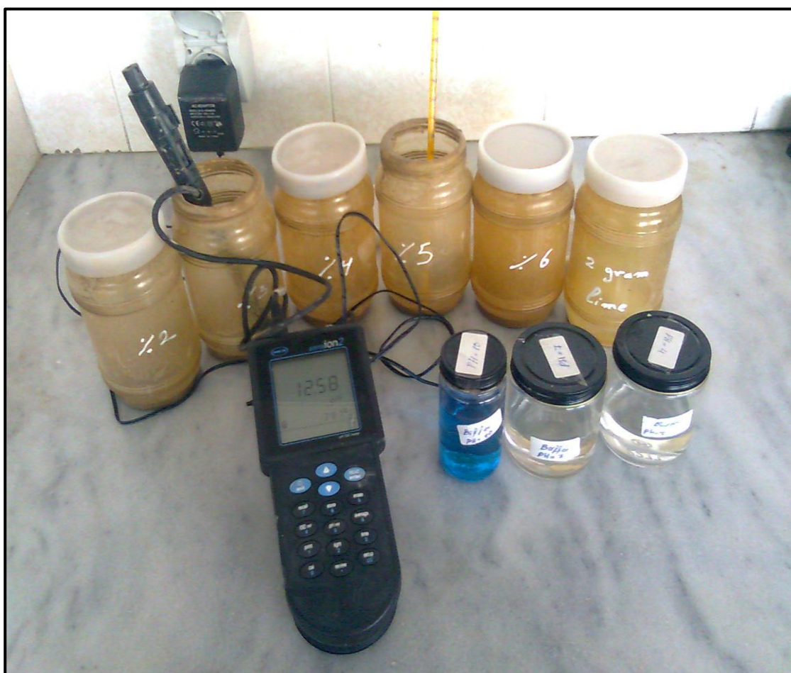
شكل رقم (91) اجراء تجربة الاستهلاك الأدنى من الكلس
