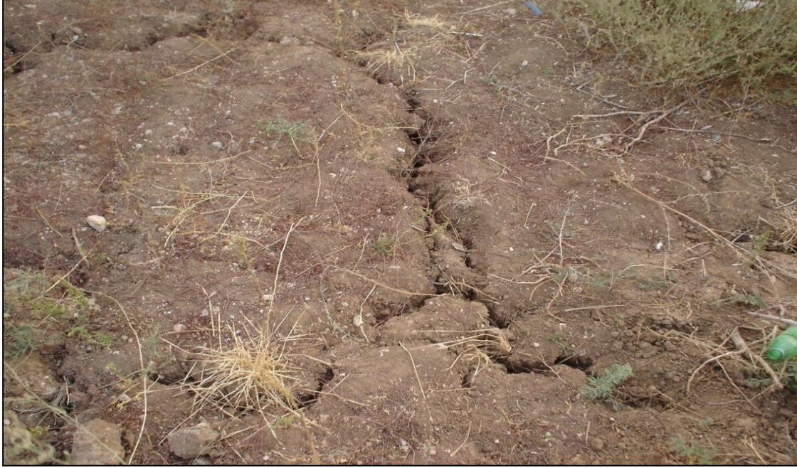
شكل رقم (1) تشققات في تربة موقع البحث الغضارية الإنتفاخية عند جفافها في فصل الصيف
