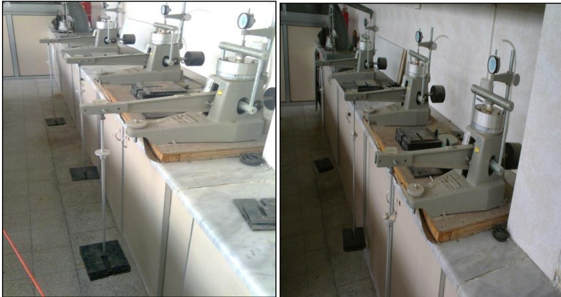
شكل رقم ( 51 ) تجارب ضغط الانتفاخ و الانتفاخ النسبي
