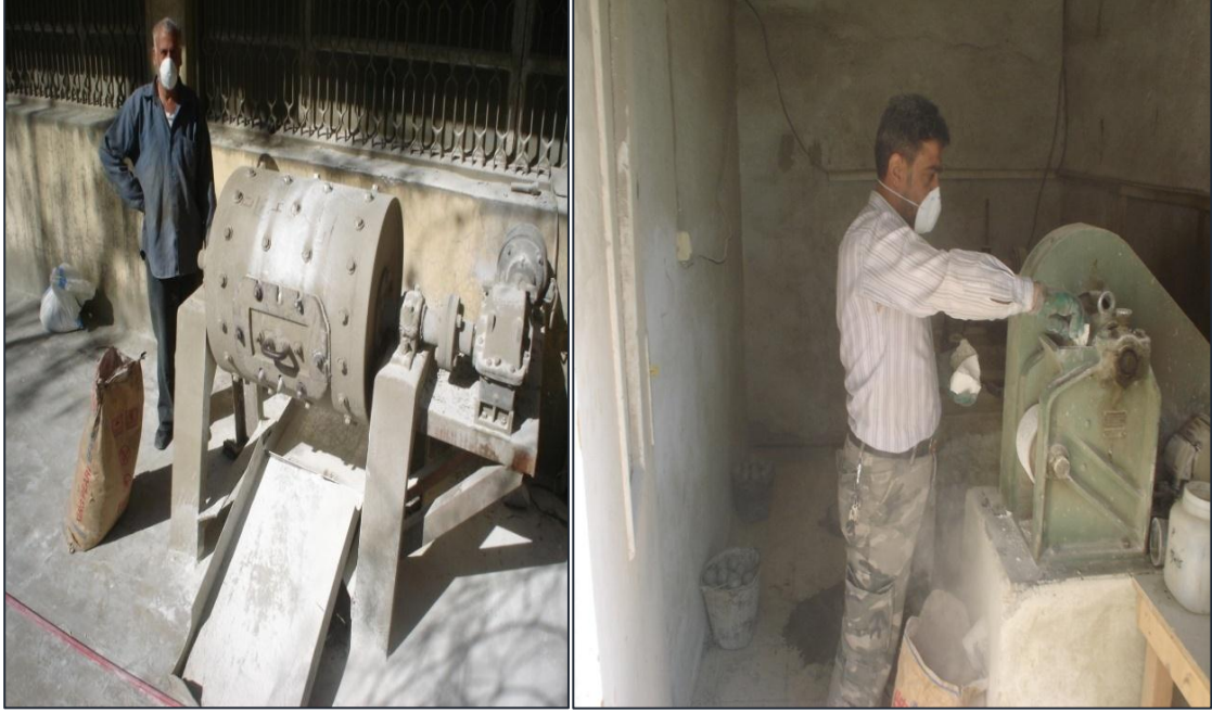
شكل رقم (21) طحن الكلس وتحضيره في معمل الاسمنت بعدرا.
