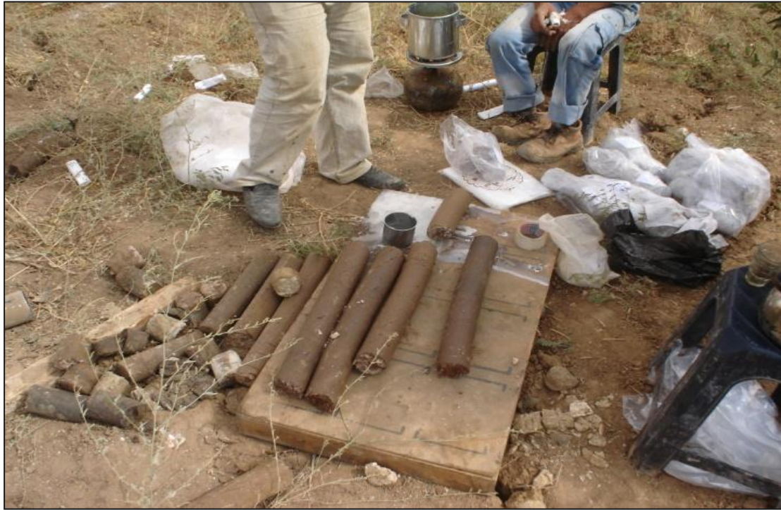
شكل رقم (12) تشميع وحفظ العينات المستخرجة من السبر المنفرد لزوم تحديد مواصفات التربة مع العمق.
