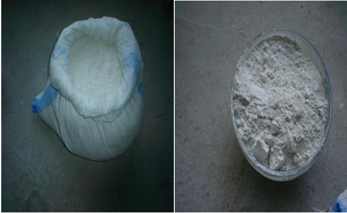
شكل رقم (7) الكلس الحي (CaO) المستخدم في البحث بعد طحنه بشكل بودرة.
